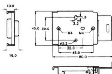
Обязательно устанавливайте реле на радиатор охлаждения, если корпус на плоскости установки реле нагревается свыше 60°C, иначе возможно повреждение реле.
