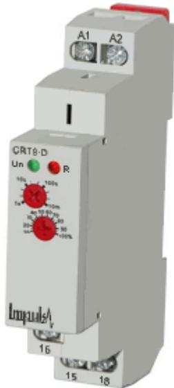
Реле времени в модульном корпусе на Din-рейку GRT8-D предназначено для автоматического выключения электротехнического оборудования с задержкой после выключения питания. Устройство имеет 1 изолированный переключающий релейный контакт для коммутации нагрузки. Выдержку времени устанавливают дискретно переключением диапазона и плавно регулировкой 10-100% внутри диапазона.
